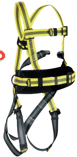
STEELPRO SAFETY ARNÉS STEELTEC-1 9691407 Arnés regulable con enganche dorsal y frontal con cinturón de posicionamiento. Anilla dorsal de doble cuerpo para mayor seguridad.
