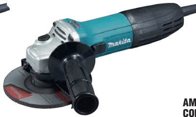
AMOLADORA CON CABLE 9683118 GA 5030R. 720 W. Ø disco 125 mm (no incluido).
