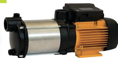
9650991 Caudal max 3900 L/H, 550W. Presión max: 4.3bar. Auto-aspirante hasta 2 m. Motor protección IPX5. Cuerpo bomba AISI 304 Eje bomba AISI 431 Temperatura máxima del agua 40°C. Versión monofásica con protección térmica incorporada. Se suministra sin cable.
