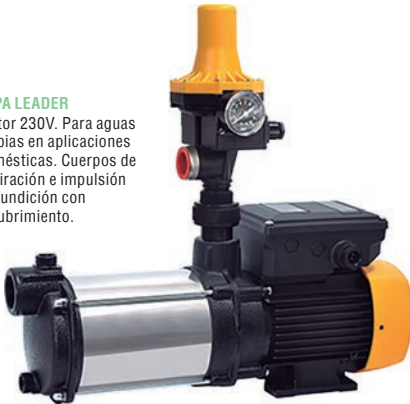
9708352 MISTRAL 33 0,45 kW. Altura máx 41 m. Caudal: 3,5 m³/h.
