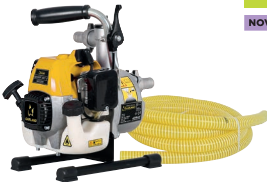
9700142 Motor 2 tiempos de 25,4 cc. Potencia 0,7 kW. Altura máxima de impulsión 35 m. Altura máxima de aspiración 8 m. Caudal máximo 7.000 L/h. Con 4 m de manguera de aspiración.
