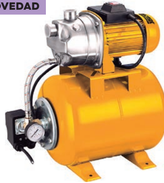
GRUPO DE PRESIÓN 23020204 Con acumulador. Potencia 1200 W. Caudal máximo 3.700 L/h.
