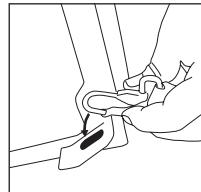
2. Conecte las mangueras al conector doble
