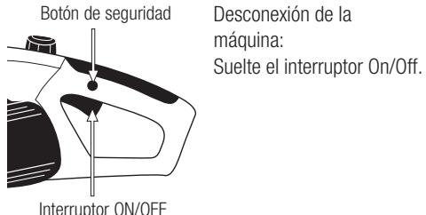
La liberación del interruptor On/Off detiene la cadena de la motosierra en menos de 0,15 s. Al liberar el botón On/Off la conexión entre motor y cadena se separa por medio de un embrague por lo que observará que la cadena para mientras el motor continua girando unos instantes.
