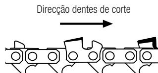
4. Montar a barra (com a cadeia instalando) e colocar a cadeia em torno do pinhão.
