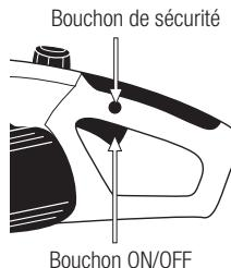
Déconnexion de la machine: Lâchez l'interrupteur ON/OFF.
