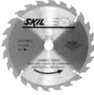
2610395706 | Hoja de sierra multiusos (Ø 184 mm, 60 dientes)  | Para el modelo: 1054, 5003, 5064, 5065, 5066, 5164, 5165, 5166, 5265, 5665, 5765, 5820, 5865, 5866<br>Embalado por: 1<br>Diámetro de la hoja de sierra: 184 mm<br>Diámetro hoja de sierra (pulgadas): 7 1/4"<br>Diámetro del eje de hoja de sierra: 16 mm<br>Dientes: 60 |
