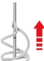
2610Z04773  | Varilla mezcladora SL85H | Para el modelo: Todos los taladros percutores<br>Embalado por: 1<br>Tipo: SL85H<br>Uso previsto: Materiales semilíquidos<br>Conexión: Eje hexagonal<br>Diámetro: 85 mm<br>Capacidad: 5-10 kg<br>Caudal: hacia arriba |
