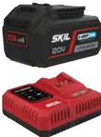
BC1E3111AA  | Batería («20V Max» (18 V) 4,0 Ah «Keep Cool» de ion-litio) y cargador «Rapid» | Para el modelo: Todas las herramientas '20V Max (18V) Energy Platform'<br>Tensión: 18 V<br>Tensión: 20 'V Max'<br>Capacidad de la batería: 4 Ah<br>Tipo de celda: Li-Ion<br>Tensión de entrada: 220-240 V V<br>Tensión de salida: 22 V V<br>Corriente de carga: 6,0 A<br>Tiempo de carga: 0.83 hrs |
