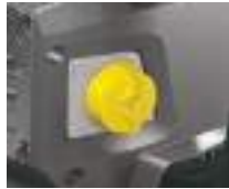
Depósito de aceite integrado con mirilla
