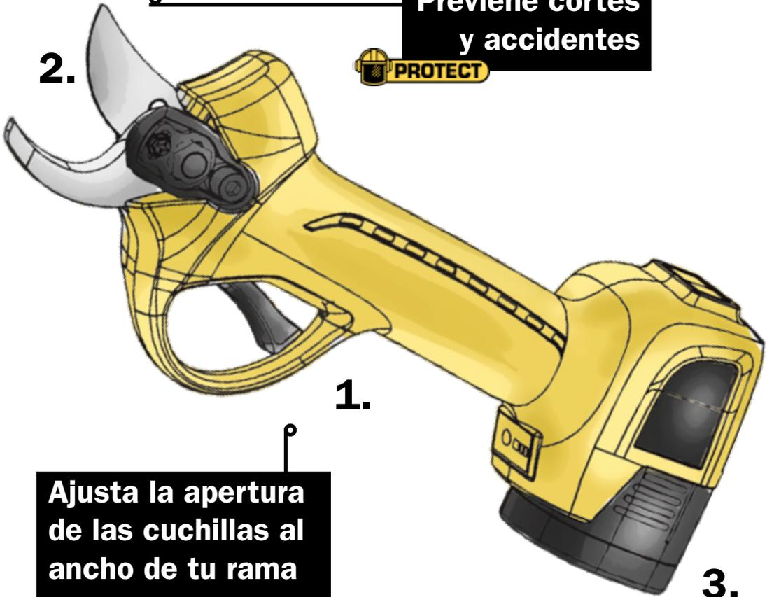
**Ajusta la apertura de las cuchillas al ancho de tu rama**
