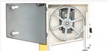
● Volantes de radio en fundición de aluminio
