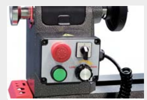
MC 1420 VFM equipado con interruptor magnético
