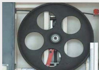
● Volantes de radio fabricados en fundición de aluminio
