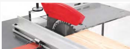
● Protector de la mesa. En función sierra circular permite el escuadrado de tableros de 1200 x 600 mm
