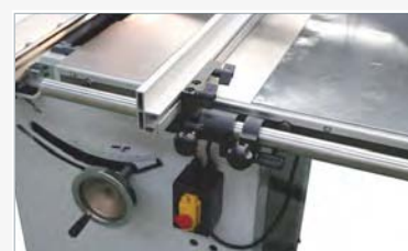
● Regulación micrométrica guía lateral
