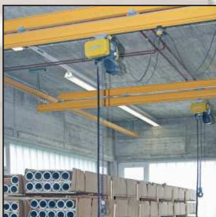
* Grúa suspendida monorraíl.
