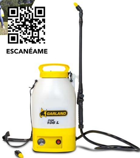
Fumigador a batería para líquidos con motor de 12 V y batería de ácido de 1,3Ah y 5 l de capacidad de depósito, con 0,6 l/min de caudal máximo y 4 bar de presión. Incluye batería y cargador.
