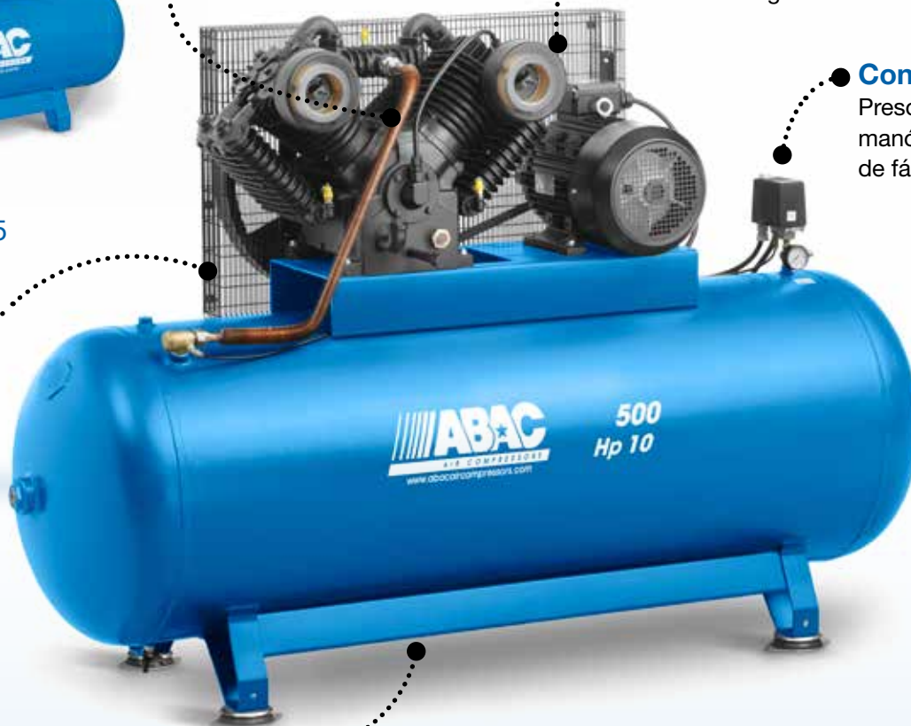
PRO CA2-500 FT10 10 hp, 500 litros, 4 cilindros
