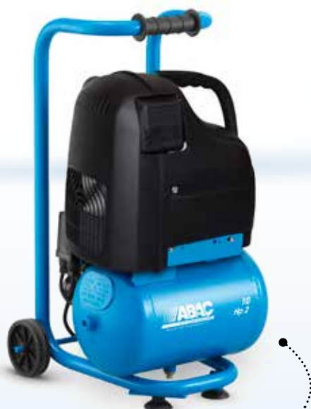
SILVERSTONE O20P 2hp, 10 litros, sin aceite, con ruedas, mango alto
